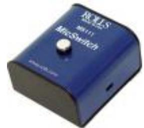
OPERATION Om du vill växla ett mikrofonensignalen på eller stänga ansluta den balanserade XLR-kabeln som kommer från mikrofonen till honan ingången på MS111 och anslut den hane med en balanserad XLR-kabel till ingången på din mixer eller nästa enhet i signalens väg. Tryck på knappen på MS111 gång för att aktivera mikrofonen, tryck på strömbrytaren igen för att stänga av mikrofonen. Omkopplaren
